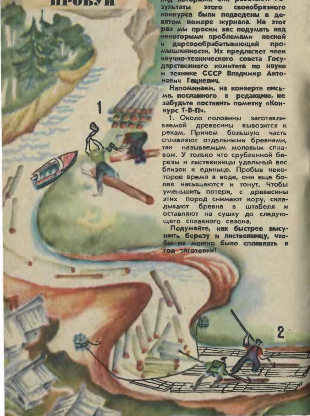
2. Для сортировки бревен на воде реку или часть реки перегородивают. Ниже по реке при помощи связанных по длине бревен устраивают коридоры по числу категорий бревен. Бревна пропускают через эти коридоры и направляют в соответствующие места для связки их в пакеты-пучки. Длина коридоров может достигать 500 м и более. Так как река перегороджена, скорость течения в коридорах небольшая, и бревна порой приходится подталкивать вручную баграми.
